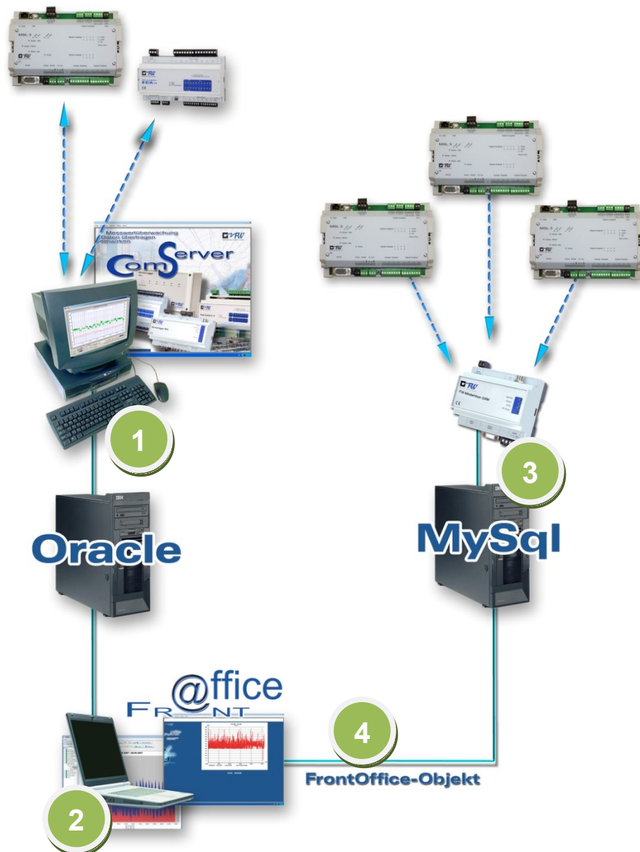
Abbildung 82) Beispielhafte Schemadarstellung „Onlinevisualisierung externer Datenbanken“
