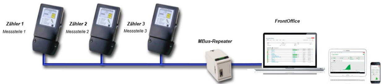
Abbildung 37) Zähler fungieren einzeln als Physikalische Messstellen.
