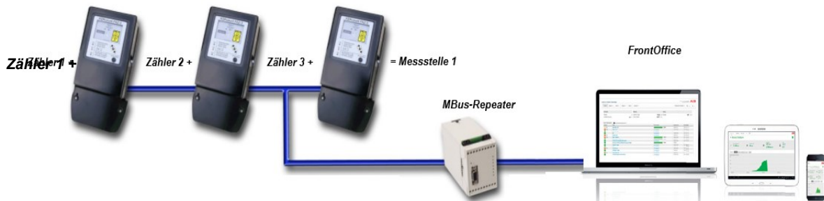
Abbildung 38) Zähler fungieren zusammengefasst als Virtuelle Messstelle.
